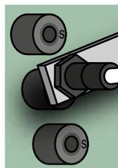
Prüfen, ob der Schalter sich in Höhe der Magnete befindet, ggf. diese nachjustieren.
